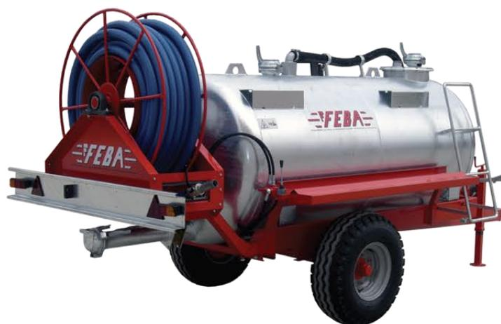
Carrobotte per spurgo con naspo idraulico
